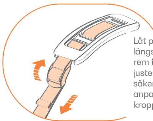
Låt plastklämmorna glida längs säkerhetsbältets rem för att justera längden; justera längden på säkerhetsbältet så att det anpassas väl efter barnets kropp.
